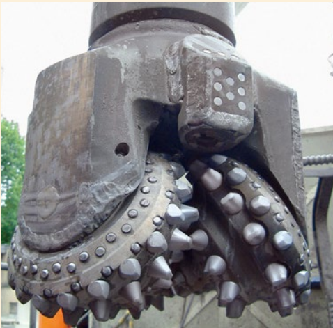
Abb. 11: Die Bohrkronen dringt mit bis zu 200 Umdre- hungen pro Minute in den Untergrund, zertrümmert das Gestein und vertieft so das Bohrloch
