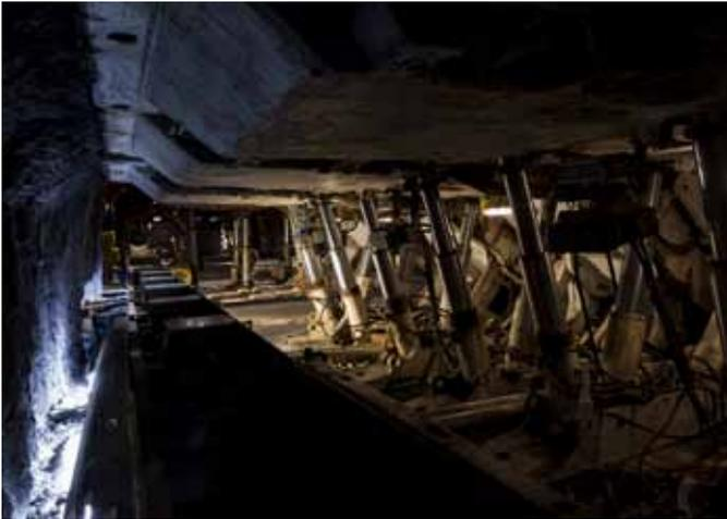
Ein originalgetreuer Hydraulik-Schild, der im Bergbau zum Abstützen des sog. Hangenden eingesetzt wurde, kann von den Besuchern im Montanium besichtigt werden.
