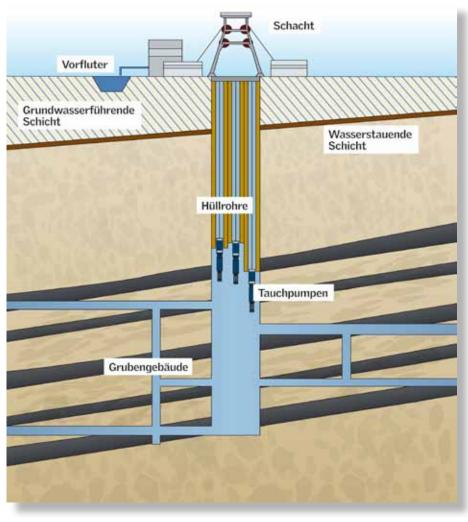
Bei der Verfüllung des Schachtes werden in der Füllsäule Hüllrohre eingebaut. Durch diese Rohre kann später eine Tauchpumpe eingehängt und betrieben werden. Das untertägige Grubengebäude ist für den Betrieb der Pumpen nicht mehr nötig.
