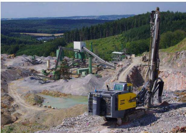
*Blick in den Massenkalksteinbruch der Firma Striker & Weiken GmbH in Hemer: Vorne ist ein Bohrgerät zum Bohren der Sprenglöcher zu sehen. Im Hintergrund befindet sich die Brecher- und Siebanlage.*
