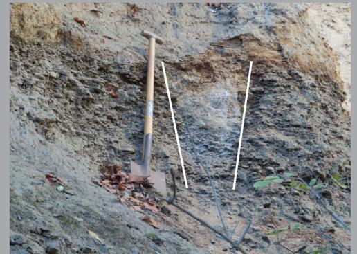
Fossiler Eiskeil im Aufschluss unter der Ruhrtalbrücke. Die Weißfärbung entstand durch Kalk, der aus dem darüberliegenden Löss ausgefällt wurde.
