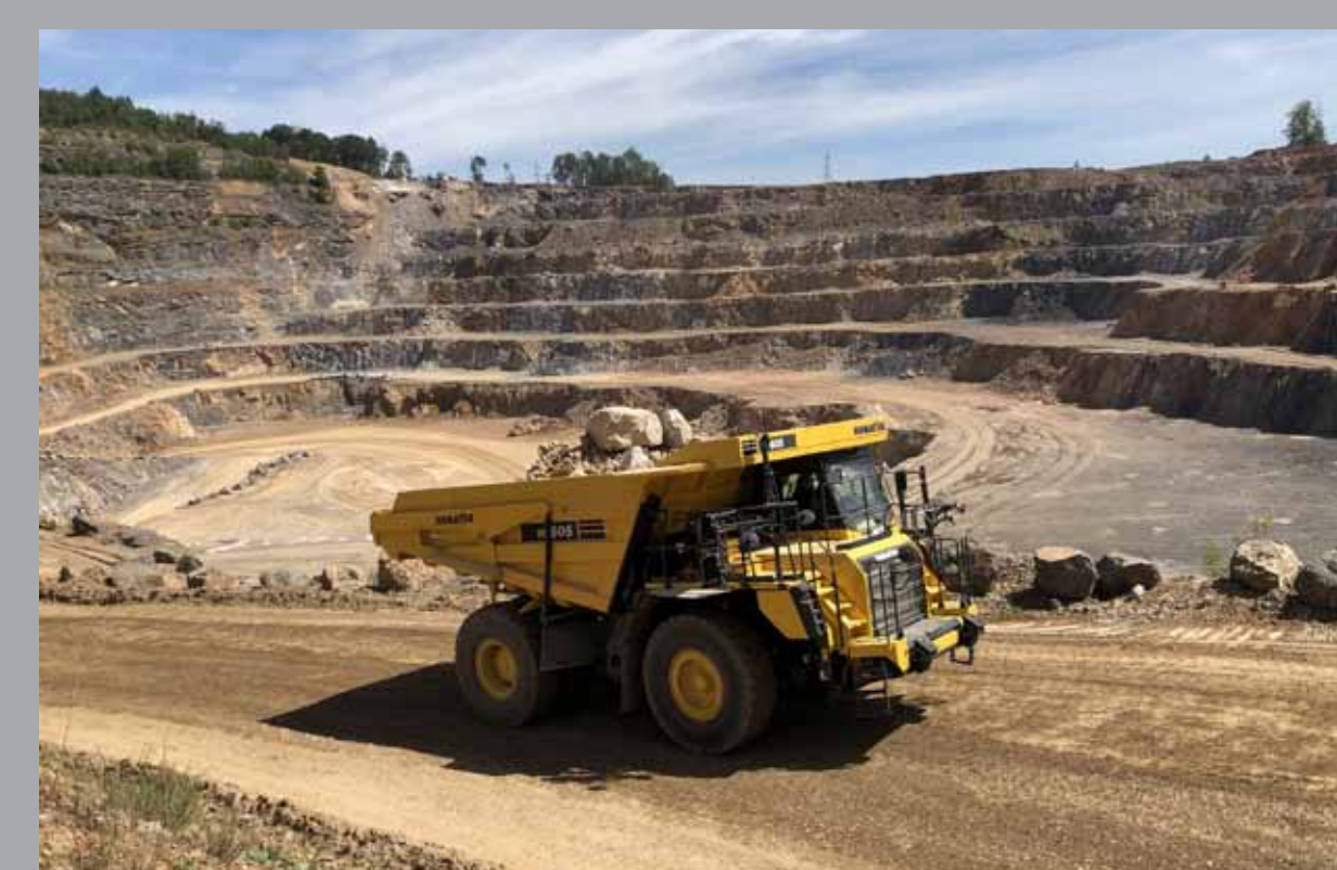
Mit dem Muldenkipper wird das Gestein vom Steinbruch zur Aufbereitung transportiert. Er hat eine Tragfähigkeit von 65 Tonnen.
