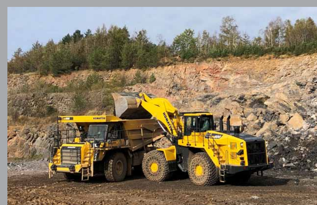
Mit dem Radlader wird das gesprengte Gestein auf den Muldenkipper geladen.
