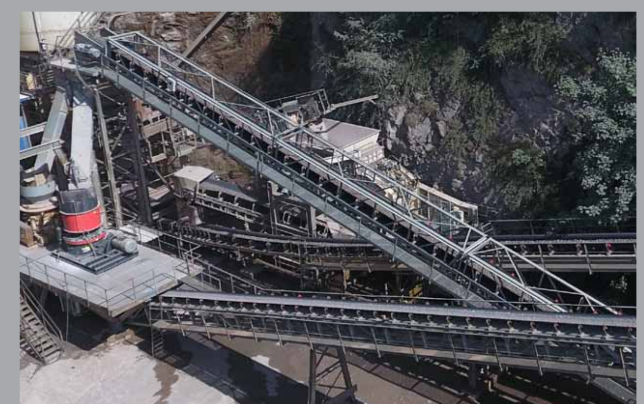
Der Kalkstein wird in der Brecheranlage zerkleinert und dann in weiteren Arbeitsschritten zu verschiedenen Produkten aufbereitet.
